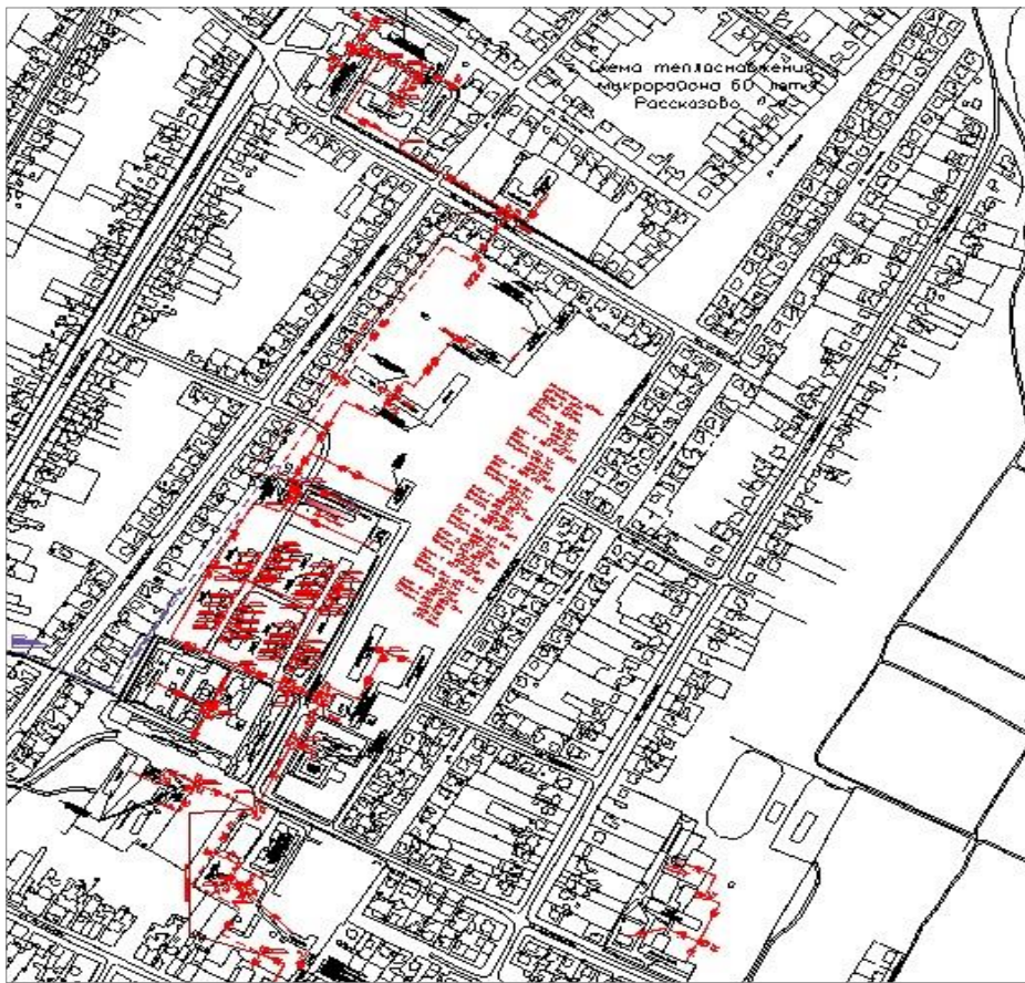
Рис. 1.1. Зона действия котельной ул. 60 лет Рассказово, 17
