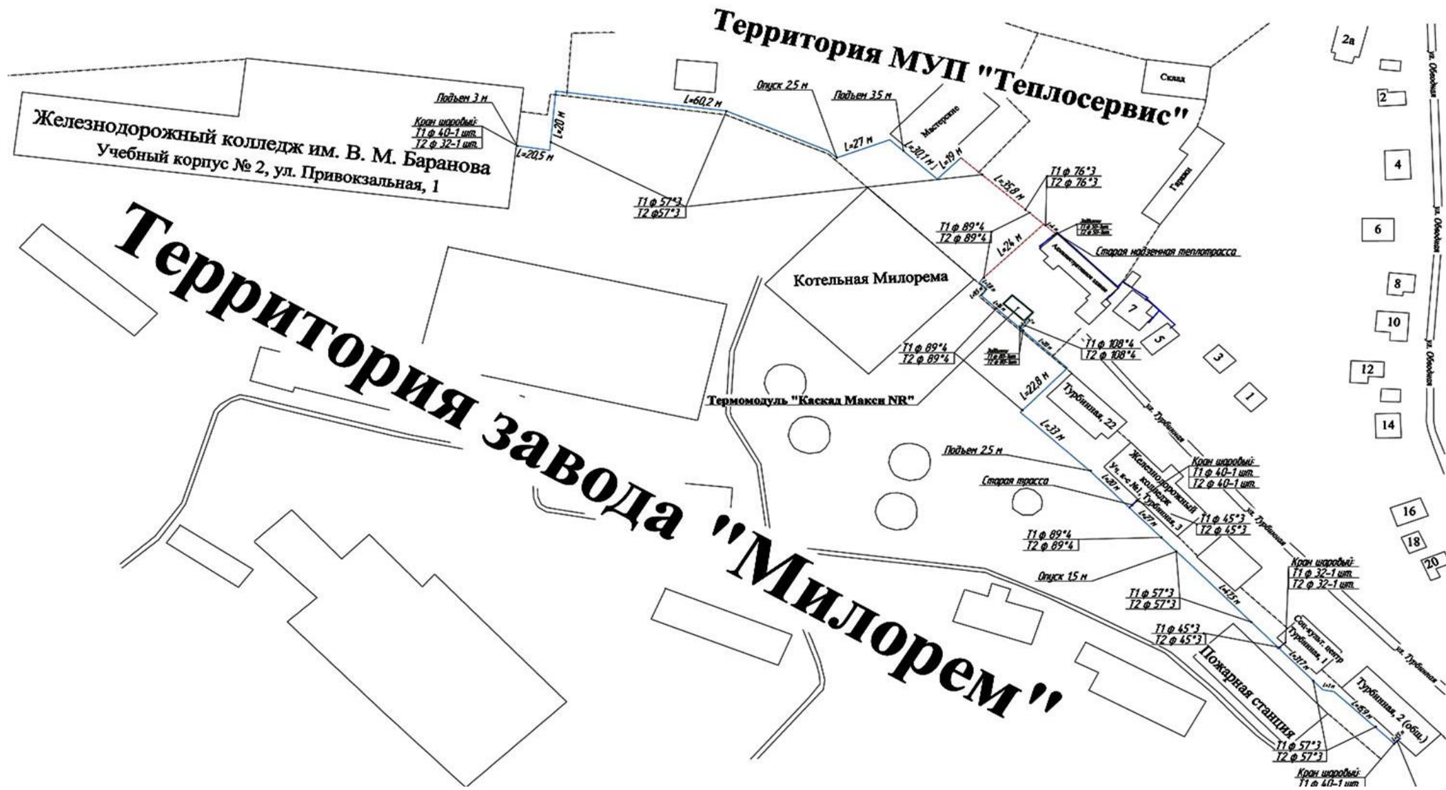
Схема теплоснабжения потребителей тепловой энергии АО «ТСК» от котельной по ул. Турбинной, 2
