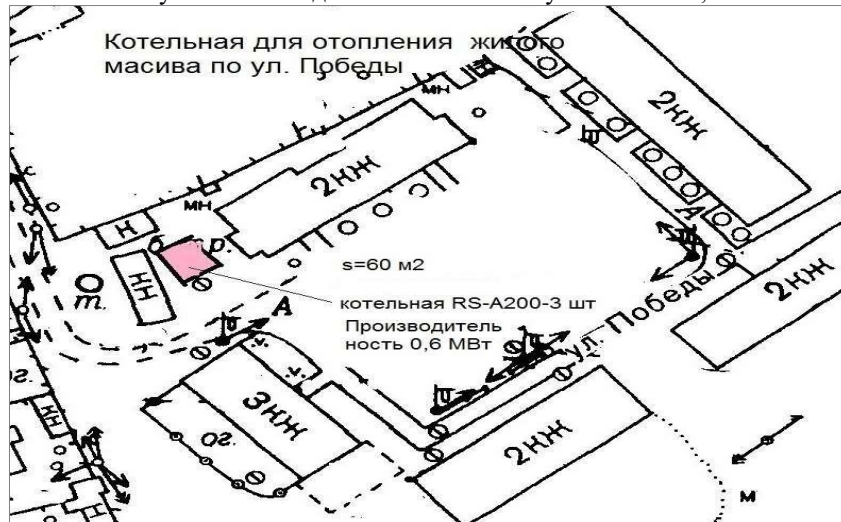
Рисунок 37 Зона действия котельной ул. Победы, 7д
