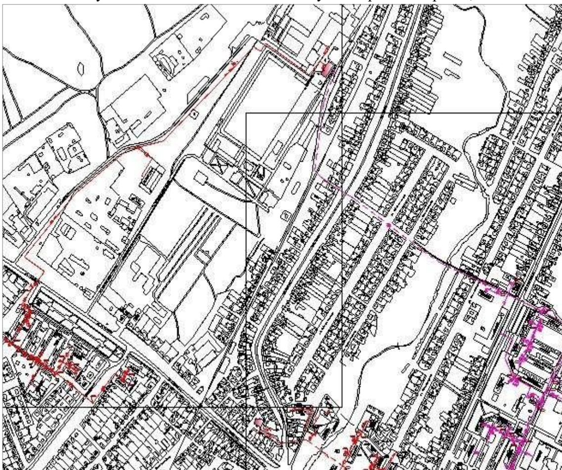
Рисунок 7 Зона действия котельной ул. Фабричный проезд, 3а.
