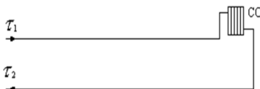
Рисунок 20 – Схема присоединения теплотребляющих установок потребителей к тепловым сетям
